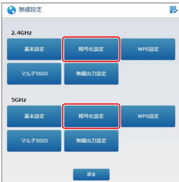
SSIDの選択でゲストSSID(guest-001)を選択し、認証方式、暗号化、キーの種類、暗号キーを設定し、[適用]をクリックします。
