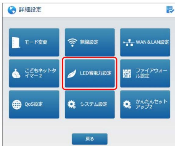
**2** LED省電力機能の「有効」を選択し、[適用]をクリックします。
