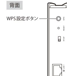
**4** 2.4GHzまたは5GHzのLEDが点灯したら接続が確立した状態となります。
