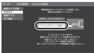
7 アクセスポイント検索が行われ、接続可能なネットワークのリストが表示されます。リストから本製品のSSIDを選択します。
