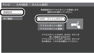
6 画面の[次へ] ボタンを押した後、本製品のWPSボタンを約5秒間押します。WPSランプが点滅したら離します。
