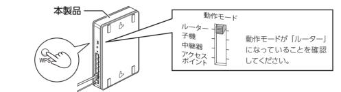
、押し続けて約 15 秒したあと WPS ボタンから手を離し、 2.4GHz ランプと 5GHz ランプが消灯していることを確認します。
