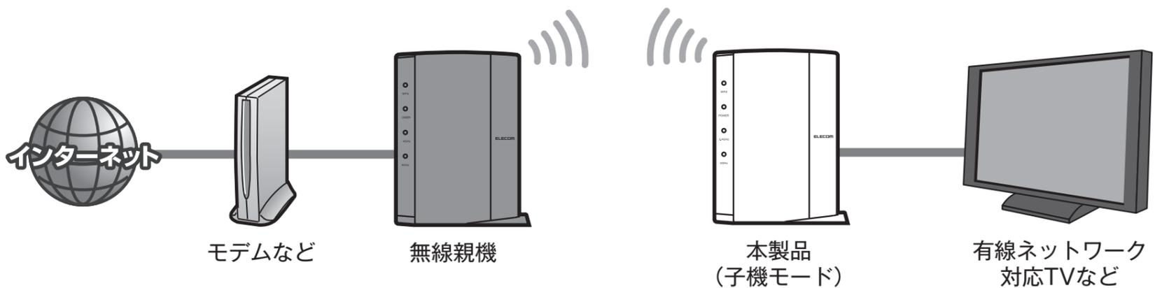
1 有線ネットワーク機器のLANポートと本製品背面にあるLANポートのいずれかをLANケーブルで接続します。
