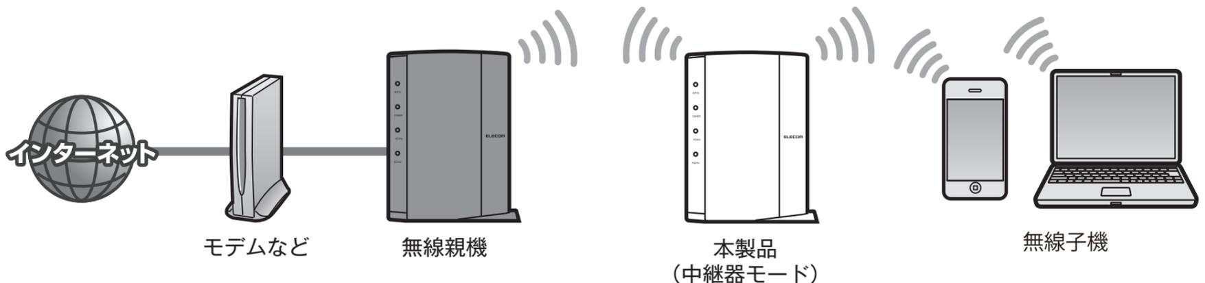
1 本製品を適切な場所に設置し、無線LAN親機にアクセスします。
