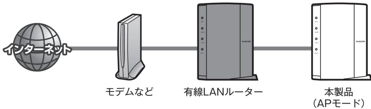
1 有線LANルーターのLANポートと本製品背面にあるLANポートのいずれかをLANケーブルで接続します。
