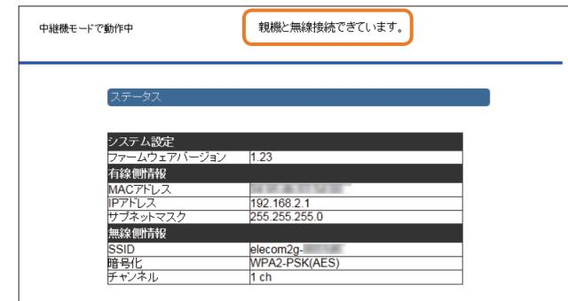
※ 2.4GHz 帯で接続した場合は、本製品の「2.4G WLAN ランプ」が点灯します。
