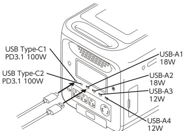
※USB Type-Cで接続機器を急速充電する場合は、USB Type-C出力ポート1または2に接続し、ケーブルはUSB Power Delivery対応のものを使用してください。また、100Wで接続機器を急速充電する場合は、100Wに対応したケーブルが必要となります。
