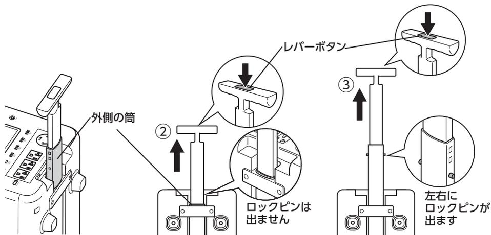
※収納型バーハンドルを長い状態で使用する場合は、必ず左右にロックピンが出ていることを確認してください。ロックピンが出ていない場合は収納型バーハンドルが固定されず、けがをするおそれがあります。
