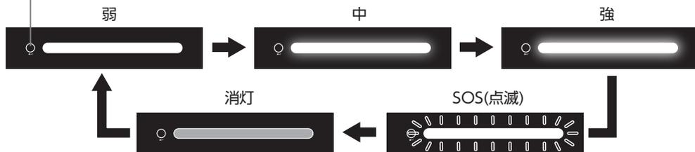
※エコモードがONの状態、LEDのみ点灯または低い電力で他の接続機器に給電している時は、最短で約2時間後にメイン電源が自動でOFFになり、LEDライトも消灯します。継続してLEDライトを点灯させ続けたい場合はエコモードをOFFにしてください。詳しくはP.16「■エコモードを切り替える」を参照してください。
