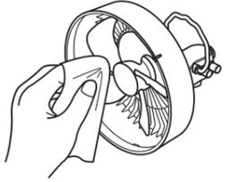
③ フロントガードの取り付け部と本体のマークを合わせて、フロントガードをセットします。
