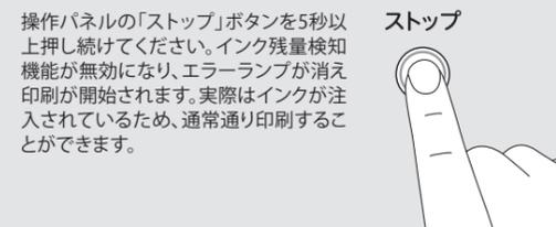
操作パネルの「ストップ」ボタンを5秒以上押し続けてください。インク残量検知機能が無効になり、エラーランプが消え印刷が開始されます。実際はインクが注入されているため、通常通り印刷することができます。
