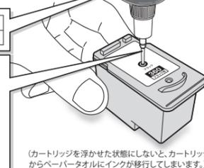
(カートリッジを浮かせた状態にしないと、カートリッジ下面からペーパータオルにインクが移行してしまいます。)
