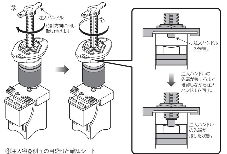
④注入容器側面の目盛りと確認シートのインクのじみ具合を見ながら、インクを注入します。インクの注入はハンドル1/4回転と5秒放置を繰り返してください。(詰め替え1回分のインク注入量はハンドル2回転分ですが、2回転に到達するより先に確認シートにインクがにじんできた場合は、ハンドルの回転を止めてください。この時点で適量のインク注入ができます。)インク注入が終わりましたら、その状態で10秒放置してください。
