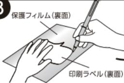
カット済みの印刷ラベルを裏にして保護フィルムの裏面(光沢のない面)に置きパンで型をとります。
