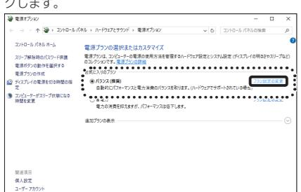
2. 「電源プラン」で選択している項目右側の「プラン設定の変更」をクリックします。
