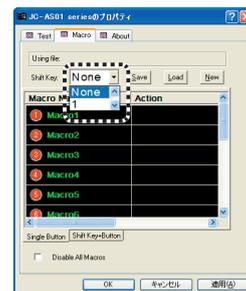
3 リスト下側にある、「Shift Key + Button」タブをクリックします。リストが「Shift Key + Button」タブの内容に変わります。
