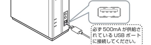
必ず 500mA が供給されている USB ポートに接続してください。
