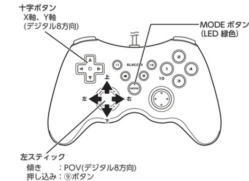
MODE ボタンが緑色に点灯しているときに X-Y 軸モードになり、十字ボタンが X 軸、Y 軸になります。
