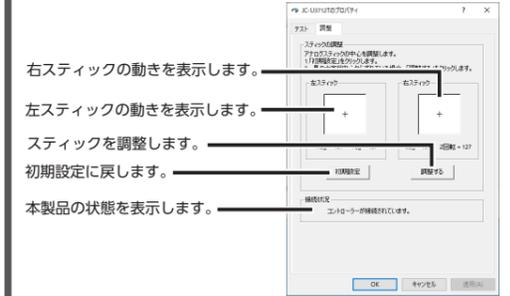
詳しくは、「スティックを調整する」(裏面)を参照してください。[テスト] タブで左右スティックのみが動作しなかった場合などに調整してください。
