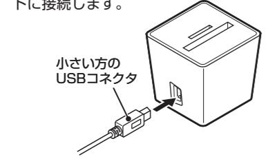
2 付属のUSBケーブルの大きい方のUSBコネクタをパソコンのUSBポートに接続します。
