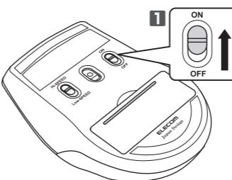
1 底面の電源スイッチをONの位置にスライドさせます。
