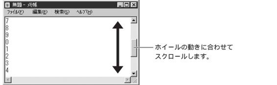
・ホイールの動きに合わせてメモ帳の作業画面が前後にスクロールすれば、マウスは正常に動作しています。
