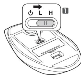
1 動作モード選択スイッチをH(ハイスピードモード)またはL(ローエナジーモード)の位置にスライドさせます。
