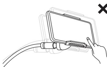
位置調整は、必ず両手でアーム部分を持って動かしてください。機器本体落下、ホルダー脱落などの恐れがあります。
