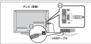
付属のUSBケーブルのコネクタを本製品のUSBポートに接続し、反対 側をテレビ背面のUSB1(録・再専用)と書かれた端子に接続します。
