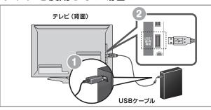
付属のUSBケーブルのコネクタを本製品のUSBポートに接続し、反対 側をテレビ背面のUSB1 (録・再専用) と書かれた端子に接続します。
