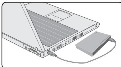
1 付属の USB ケーブルのコネクタを本製品の USB ポートに接続し、反対側をパソコンの USB ポートに接続します。
