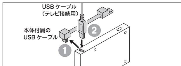
ハードディスクに付属の USB ケーブルを取り外して、同梱の USB ケーブル(テレビ接続用)を接続します。
