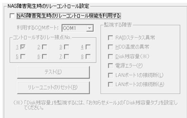
NASに障害が発生した際に、RS-232Cポートを利用して株式会社パトライト製のインターフェースコンバーターに対して信号を送信する機能の設定です。
