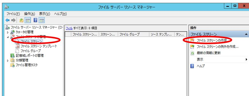
ファイルスクリーンの作成が起動しますので、各項目を設定し、作成をクリックします。
