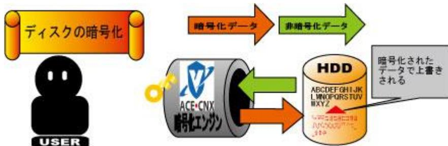
HDD 内のデータを暗号化します。オプションにより既存の HDD 内の非暗号化データを読み込み、暗号化してから HDD に上書きする事も可能です。暗号化の際にパスワードを登録します。このパスワードが暗号化した HDD にアクセスするための「キー(鍵)」となりますので、厳重に管理してください。
