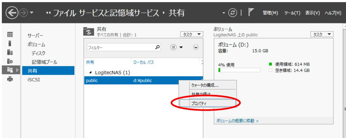
②共有フォルダのプロパティが表示されますので、「アクセス許可をカスタマイズする」ボタンをクリックします。
