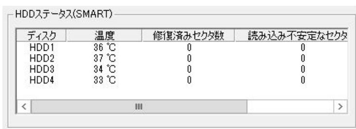
内蔵 HDD の SMART 取得情報を表示します。
