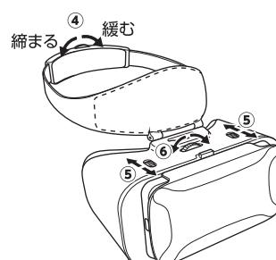
④ 「ヘッドバンド長さ調整ダイヤル」でヘッドバンドを緩めてから頭にかぶり締め付けて頭に取り付けます。
