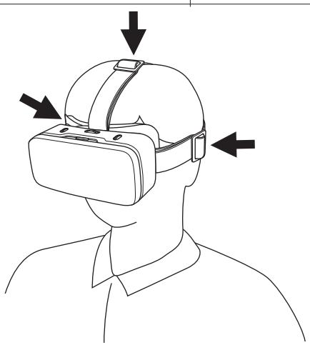
3か所のアジャスターでヘッドバンドの長さを調節し、頭に装着してください。
