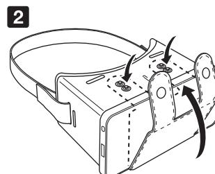
液晶画面の中央と仕切りが重なるようにスマートフォンをセットし、前面フタの留め具を閉めてください。
