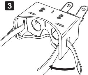
側面のバンド固定穴にバンドを通して、適度な長さで図のように折り返しマジックテープで固定してください。
