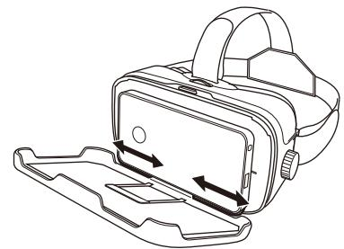
液晶画面の中央が本製品の中央線に合うようにスマートフォンをセットしてください。
