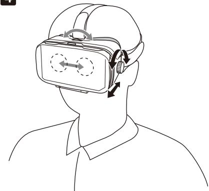
目幅調節ダイヤルとピント調節ダイヤルを動かし、目幅とピントを調節してください。
