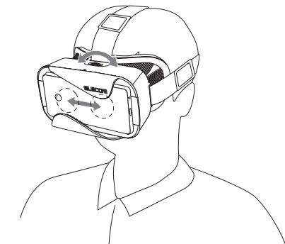
目幅調節ダイヤルを動かし、目幅を調節してください。
