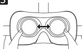
レンズの両側のふちを指で左右に押し、目幅を調節してください。
