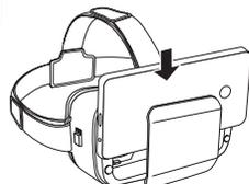
液晶画面の中央が本製品の中央位置(矢印)に合うようにスマートフォンをセットしてください。
