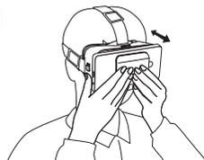
スマートフォン固定部をゆっくりと押し戻し、ピントを調節してください。
